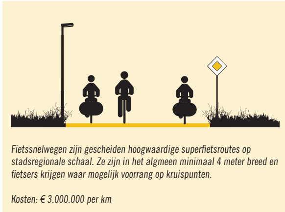
Afbeelding 9: Principe 'Fietssnelweg aanleggen'
