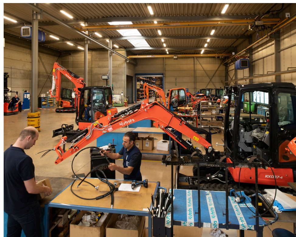
Afb. 2. Eind-assemblage van graafmachines uit internationaal geproduceerde onderdelen. Broekman Logistics Born. Foto: Rufus de Vries.
