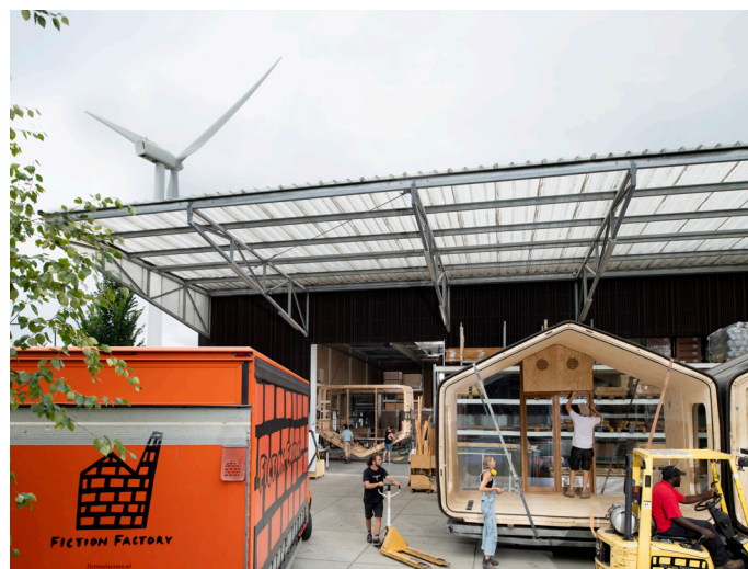
Afb. 3. Productie van prefab woningen uit karton, hout en andere grotere circulaire materialen, in combinatie met voor- en natransport. Wikkellhouse, Amsterdam. Foto: Rufus de Vries.
