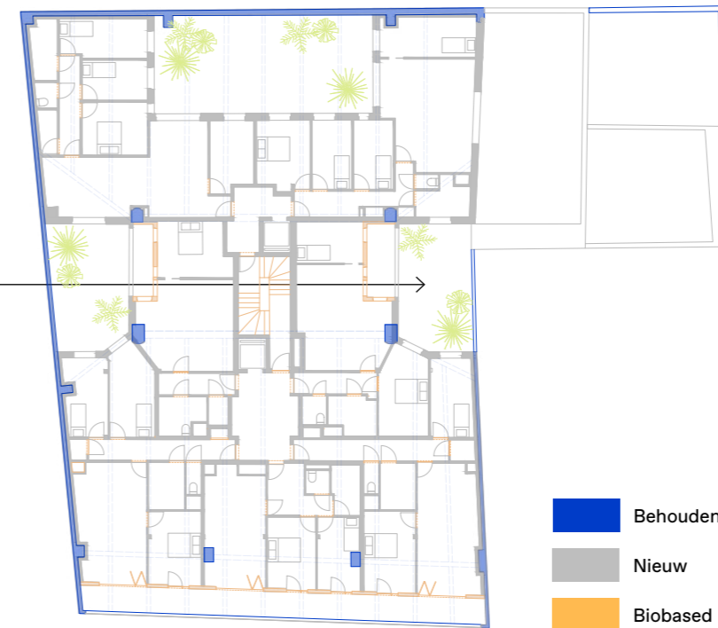
Plattegrond na de transformatie
