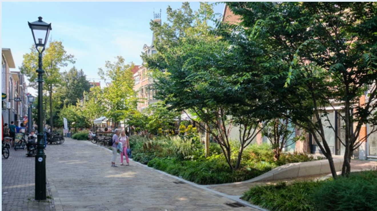
Afbeelding 115. De Laat in Alkmaar is door Bureau B+B in 2023 getransformeerd van een stenige winkelstraat met hittestress en wateroverlast tot een groene, klimaatadaptieve verblijfsruimte. Verdiepte plantvakken, bloeiende beplanting en meer dan 60 nieuwe bomen zorgen voor verkoeling, waterberging en schaduw. Zo krijgt de historische binnenstad een leefbaardere openbare ruimte met plek voor ontmoeting, terrassen en ontspanning. Foto: Bureau B+B stedenbouw en landschapsarchitectuur.
