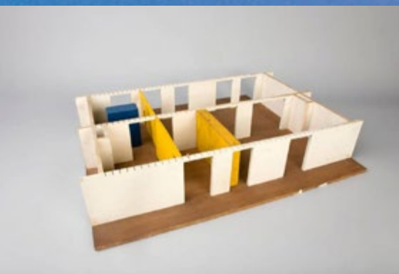
Afbeelding 26. Maquette van het interieur van een flexibele module, ontwikkeld door SAR, bestaande uit drie dragende muren en twee aanpasbare wanden. (1969-72). Beeld: Collectie Het Nieuwe Instituut Rotterdam, Archief SARE.
